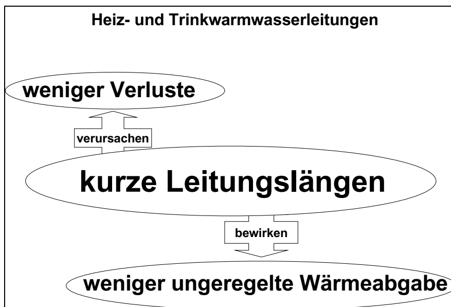
Bild 15: Heiz- und Trinkwarmwasserleitungen
