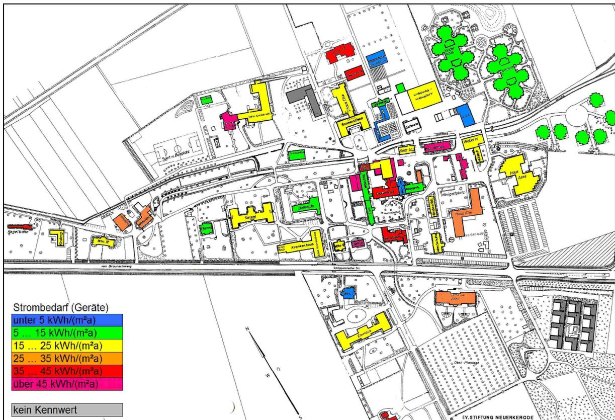
Bild 72 Strombilanz nach Umsetzung des Gerätetausches
