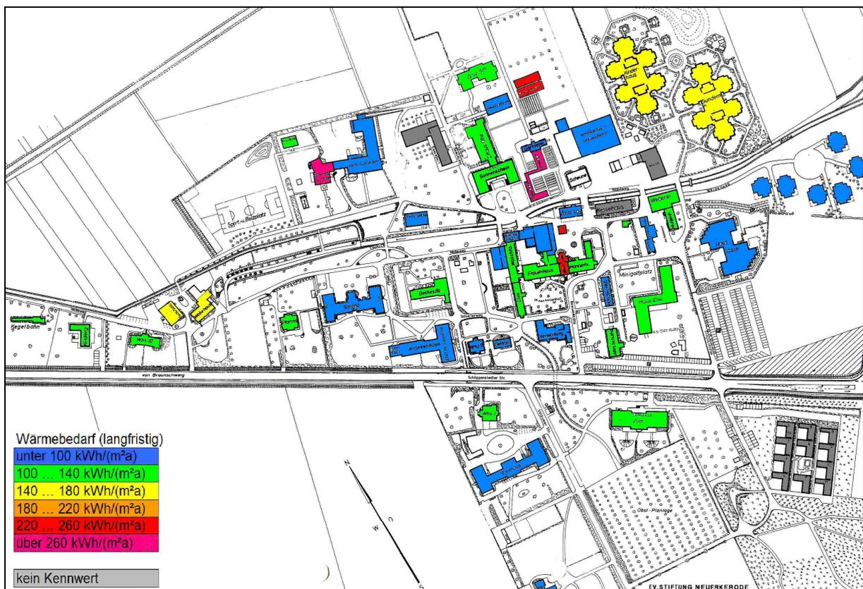
**Bild 5 Bilanz (Wärme) nach Umsetzung mittel- und langfristiger Maßnahmen**
