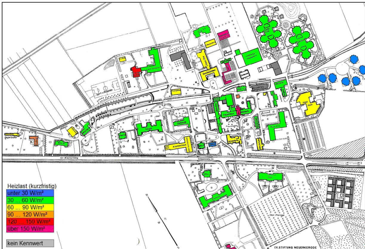
Bild 68 Heizlastabschätzung nach Umsetzung kurzfristiger Maßnahmen
