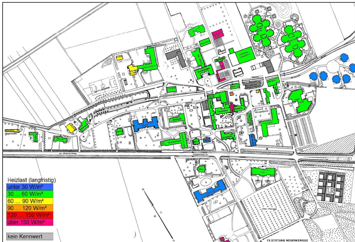
**Bild 69 Heizlastabschätzung nach Umsetzung langfristiger Maßnahmen**
