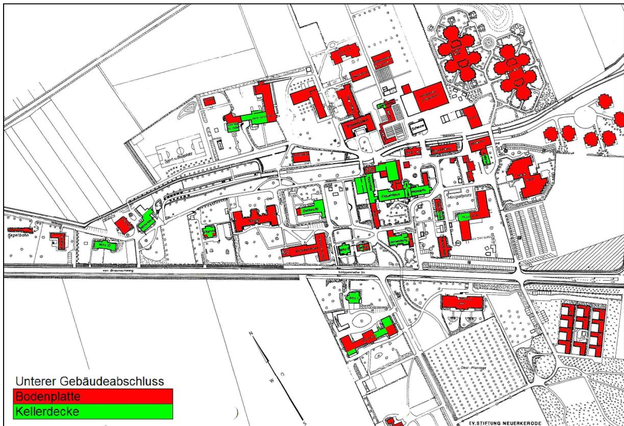
**Bild 56 Ausführung des unteren Gebäudeabschlusses**
