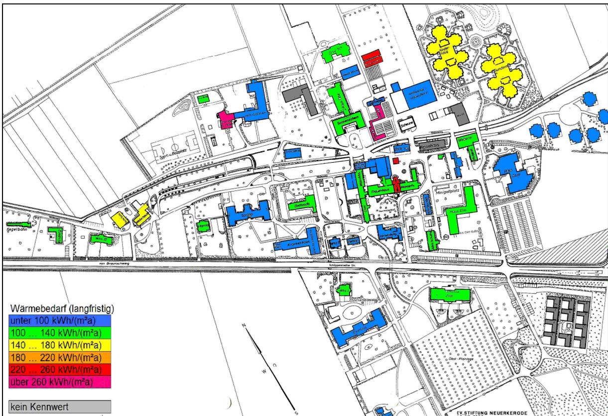
Bild 66 Bilanz (Wärme) nach Umsetzung mittel- und langfristiger Maßnahmen
