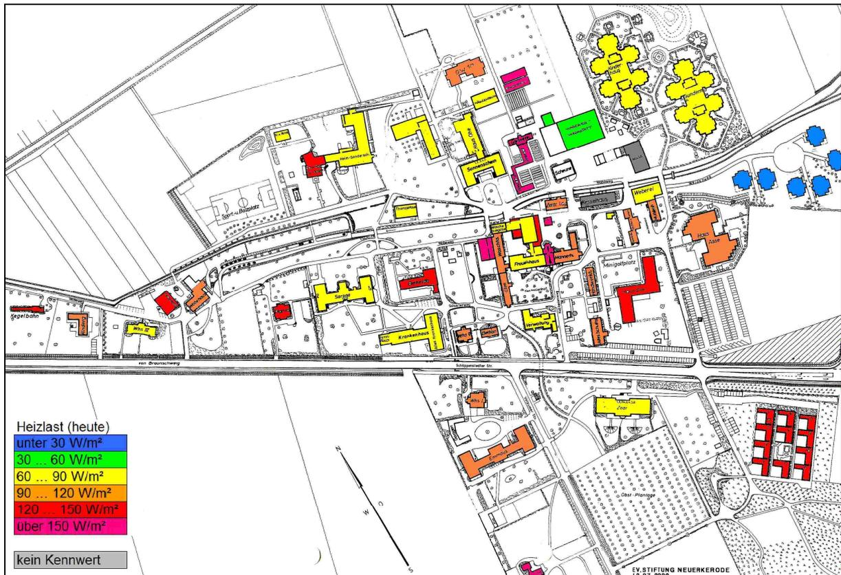
Bild 67 Heizlastabschätzung Bestand
