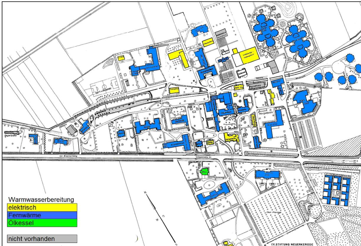
**Bild 58 Art der Warmwasserversorgung**
