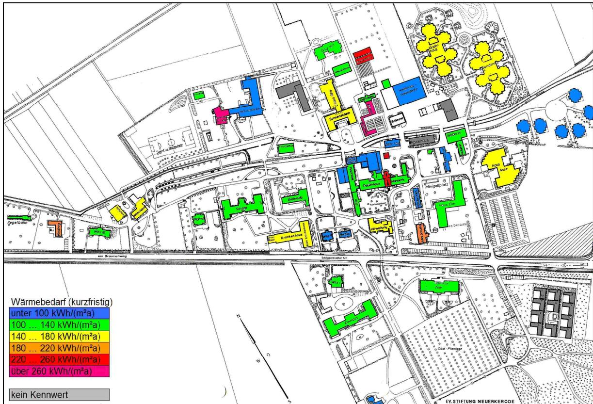
**Bild 4 Bilanz (Wärme) nach Umsetzung kurzfristiger Maßnahmen**
