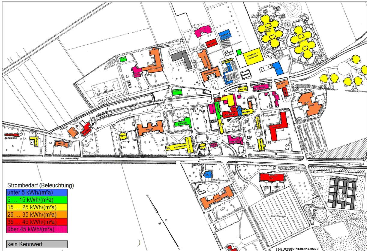
Bild 71 Strombilanz nach Umsetzung der Beleuchtungsmodernisierung
