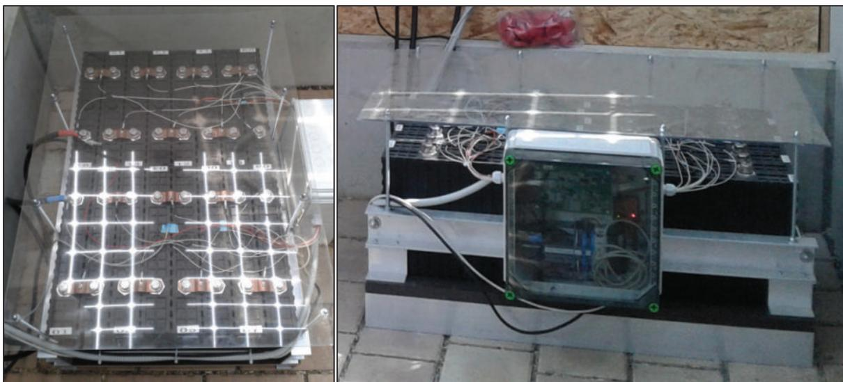
Abbildung 3-32: Komplettbatterie Lithium
