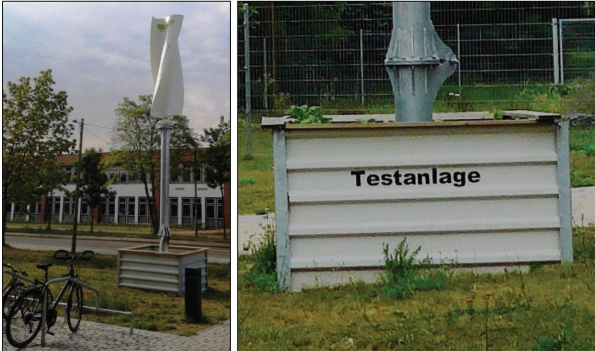
**Abbildung 1-3: Vertikale Windturbine**
