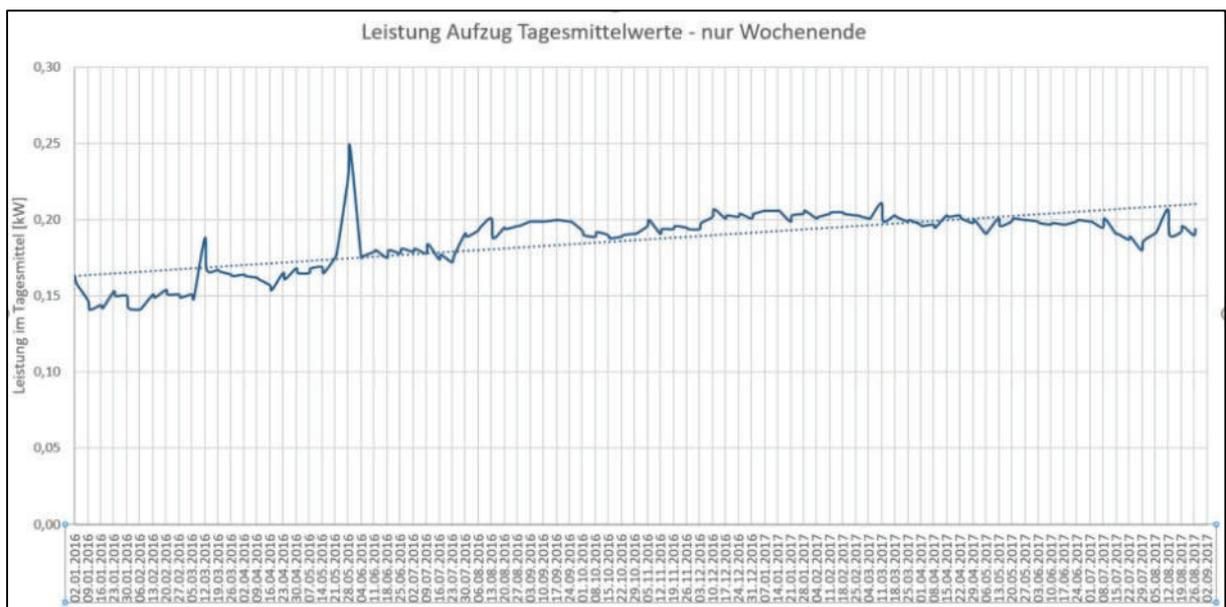
Abbildung 7-103: Tagesmittelwerte der Leistungsaufnahme des Aufzuges an Wochenenden
