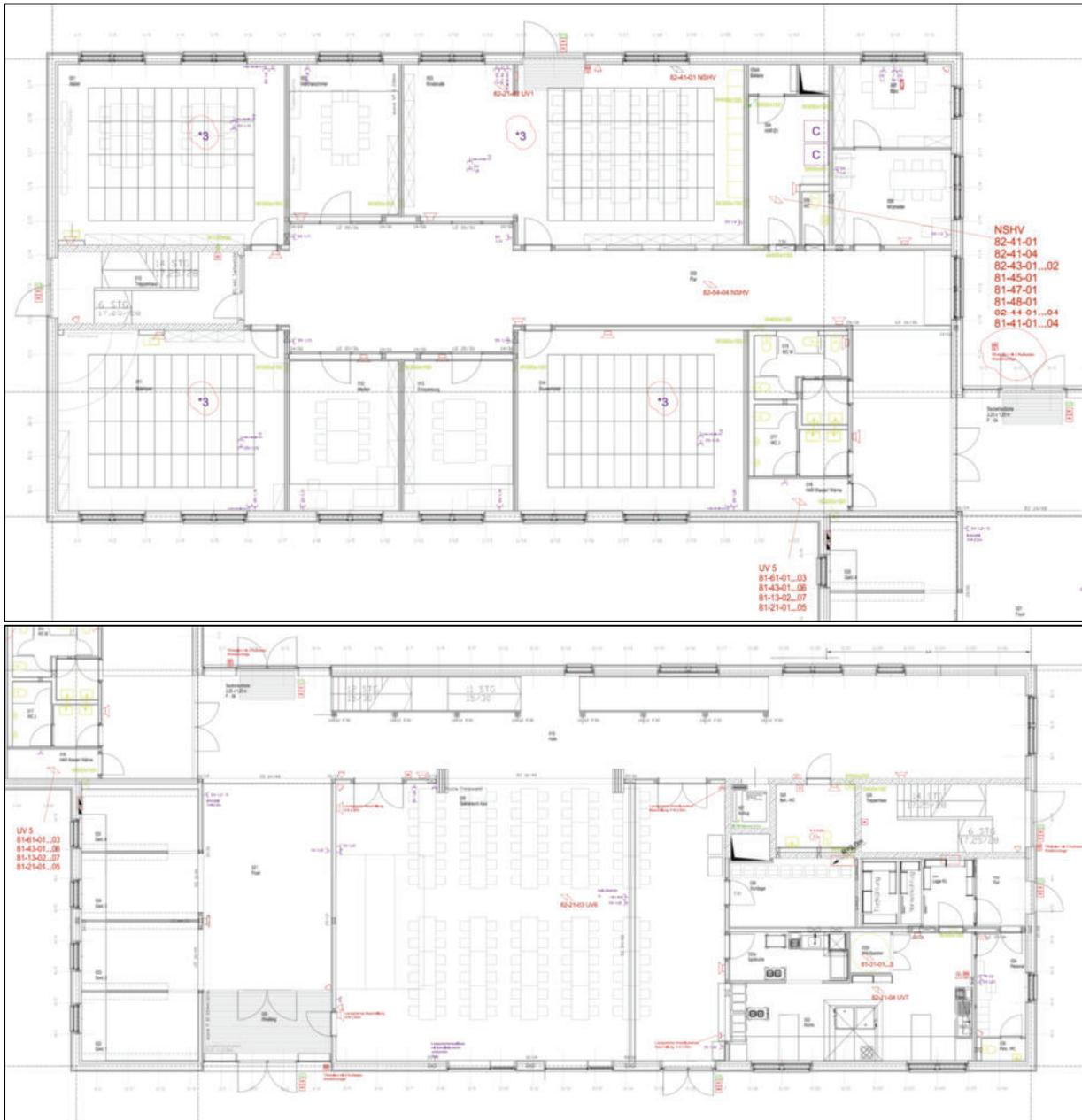
Abbildung 3-5: Schwachstrominstallation – Erdgeschoss [1]
