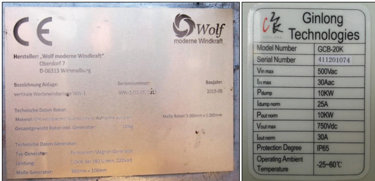
Abbildung 3-30: Typenschilder Mikrowindkraft und Gleichrichter
