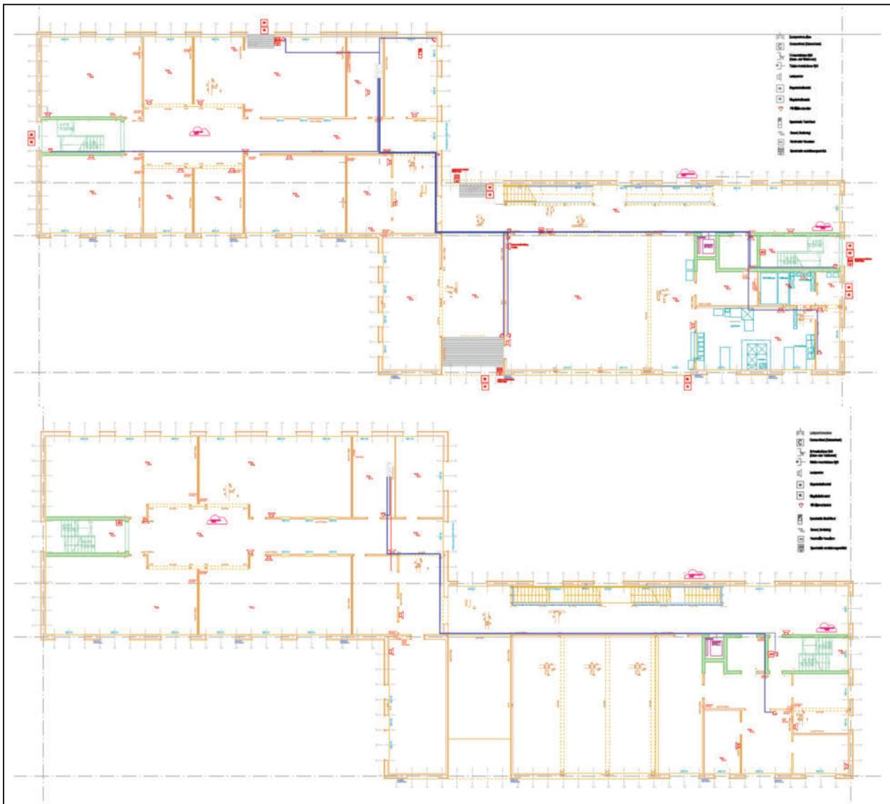
Abbildung 8-8: Leitungsführung Einbruchschutzanlage – EG, 1.OG [10]
