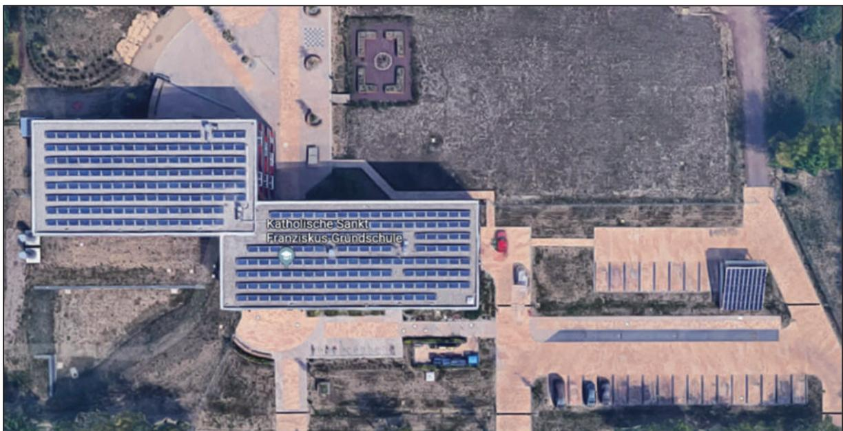
Abbildung 3-18: Komplettansicht der PV auf dem Dach und Carport [Bildquelle: Google Maps]
