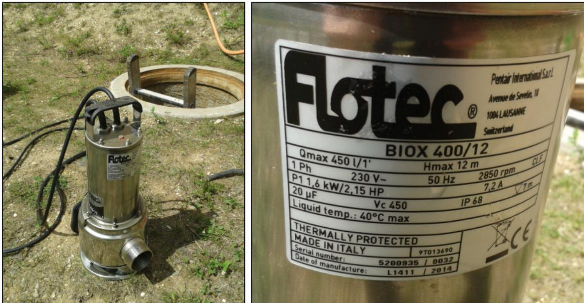
Abbildung 4-9: Zisternentauchpumpe und Typenschild
