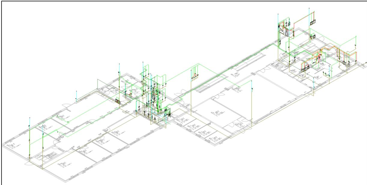
**Abbildung 1-2: Isometrie der Trinkwasser-, Brauchwasser- und Abwassernetze**
