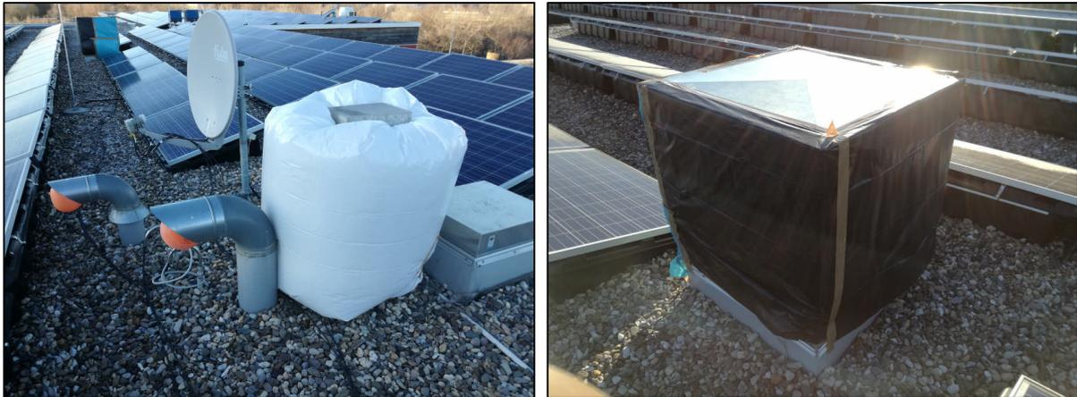
Abbildung II-42: Links: Präparation der Fortluftöffnungen des Gebäudeteils A [25]
