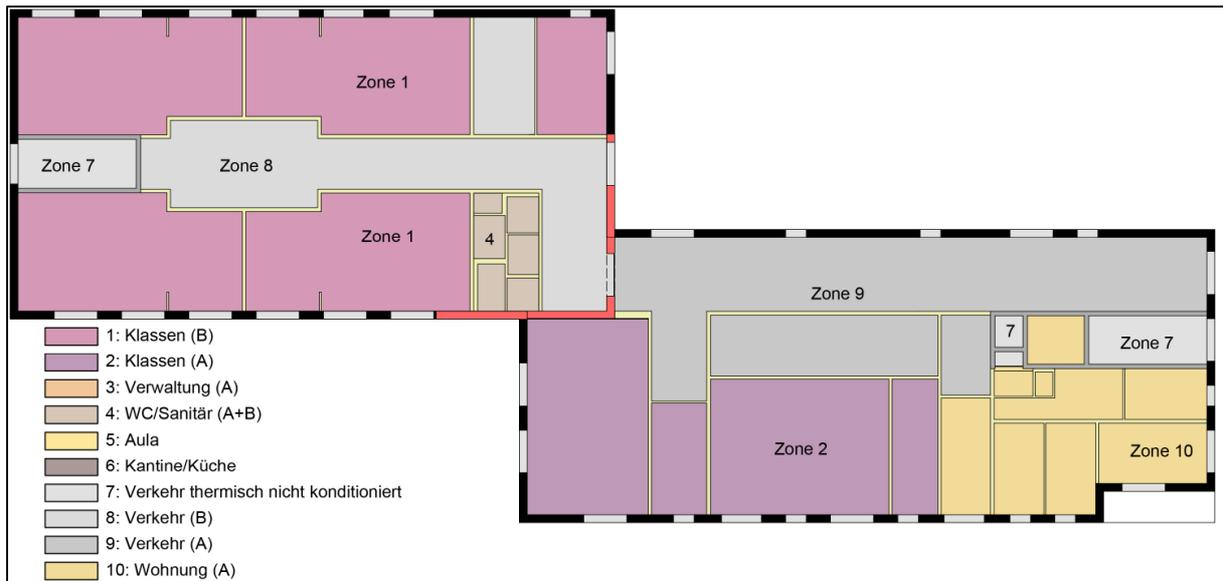
**Abbildung 5-3: Grundriss 2. OG mit Zonierung**
