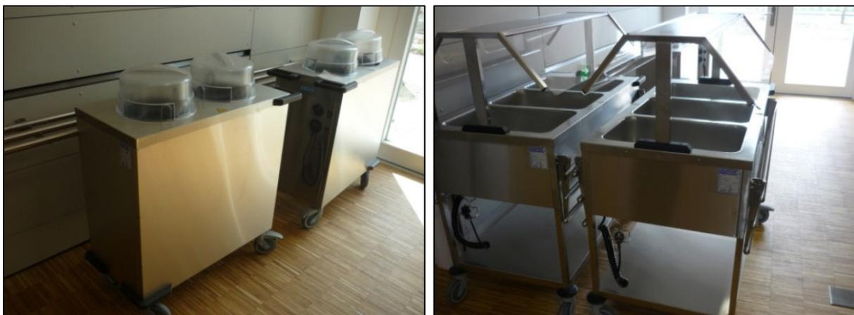
**Abbildung 8-5: Tellerwärmer und Warmhaltebecken Fa. Hupfer**
