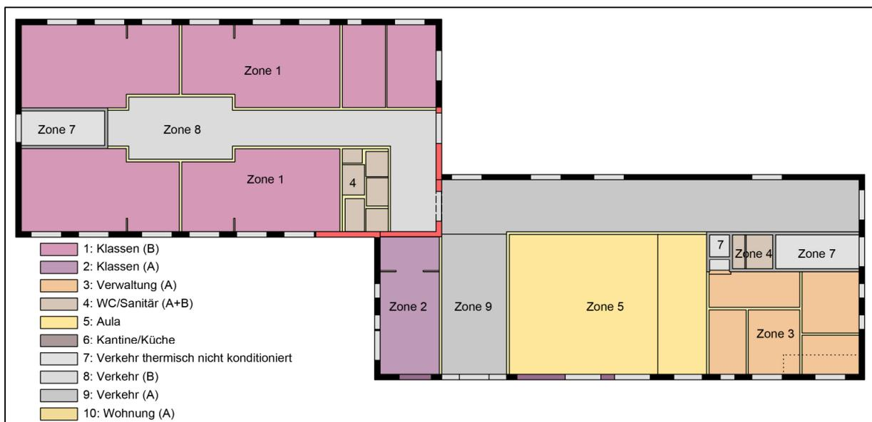
Abbildung 5-2: Grundriss 1. OG mit Zonierung
