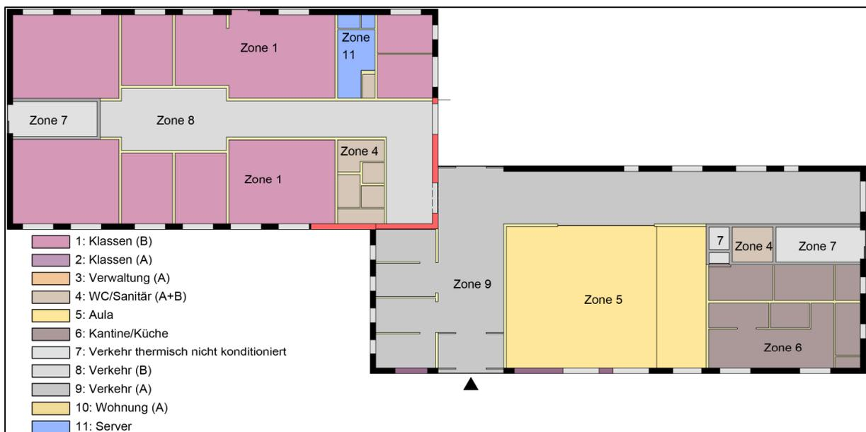
Abbildung 5-1: Grundriss EG mit Zonierung
