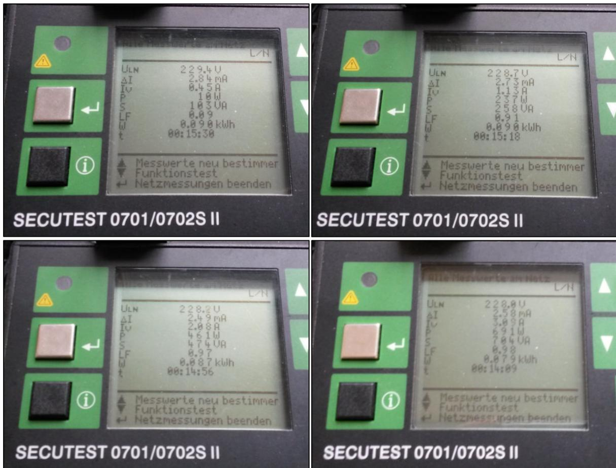
Abbildung 4-36: Blindstrommessung der Klassenraumbelichtung
