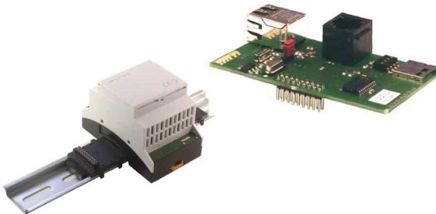
simEthernet Modul auf Hutschiene und simBus-Verbinder ohne Modul, nur in Hutschiene eingeklippt.
