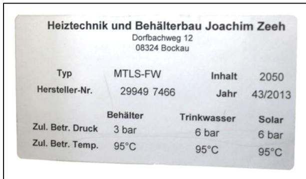
Abbildung 3-9: Typenschild Pufferspeicher (Foto: HS MD)
