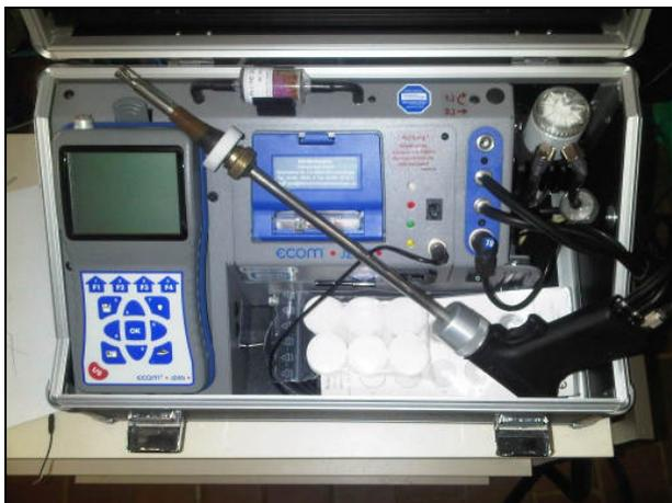
Abbildung 7: Abgasanalysegerät
