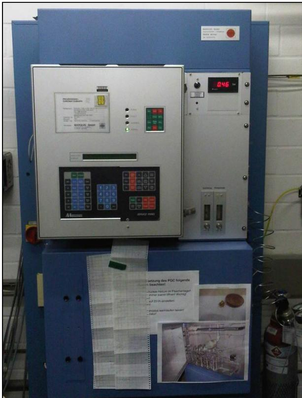
**Abbildung 3: Kalorimeter**
