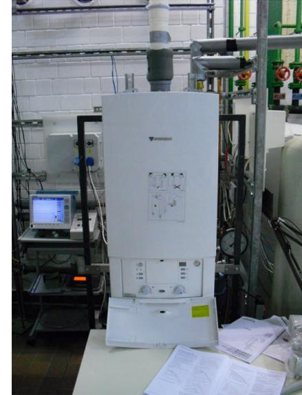
1. Prüfstand: Stationäre Wirkungsgradpunkte
