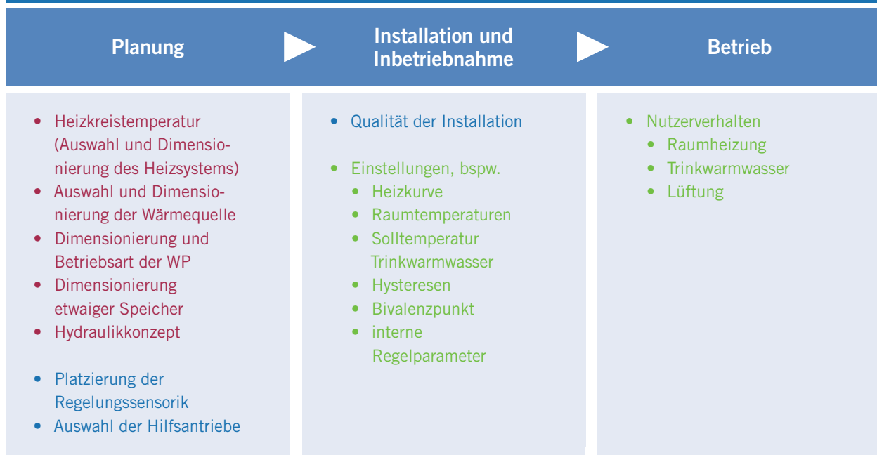
Abb. 32 Wärmepumpen: Einflüsse auf die Effizienz, wobei die Schriftfarbe den Aufwand einer Fehlerbehebung von hoch (rot) über mittel (blau) bis hin zu gering (grün) bewertet
