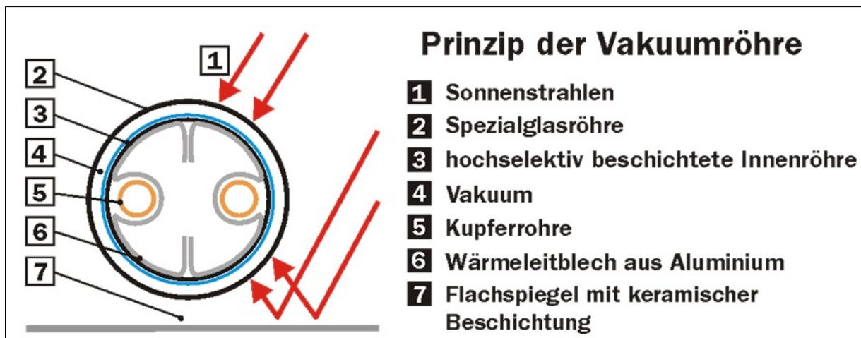
Abbildung 8: Funktionsprinzip eines Vakuurröhrenkollektors [5]
