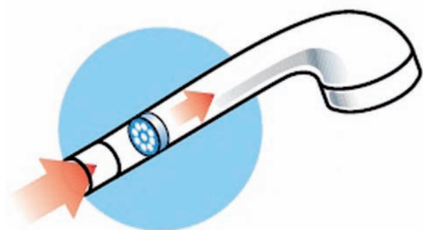
Abbildung: Sparbrause mit integriertem Durchflussregler Quelle: BfE 2002
