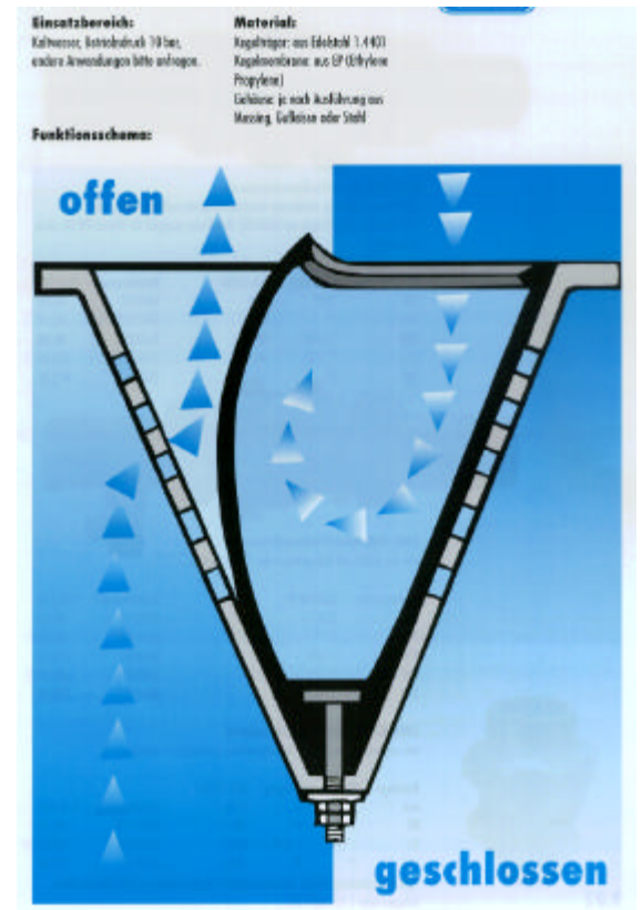
Rückflußverhinderer in einem Schrägsitzventil
