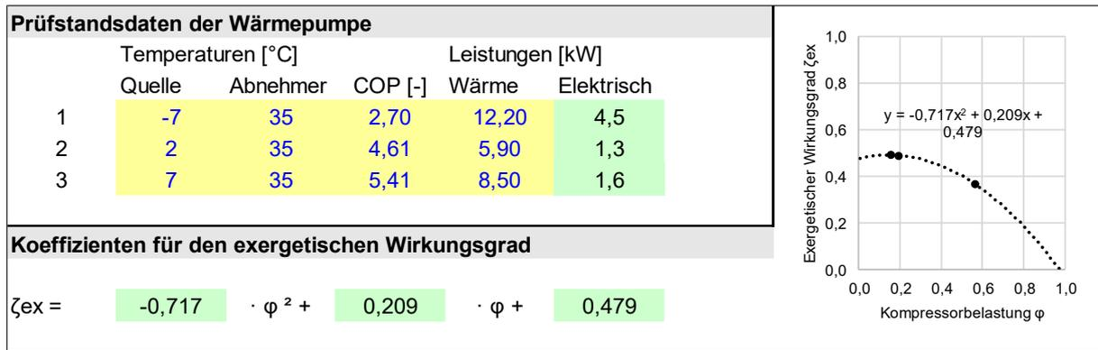
Abbildung 20 Eingaben von Wärmepumpenprüfstandsdaten in der „Energieanalyse“
