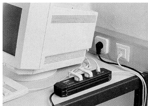
Abb.7.1.5: Zone 3 des EMV-Schutzzonenkonzepts, c t 17/1999, S.141
