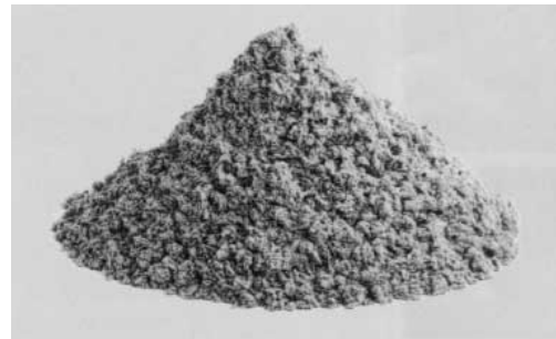
Die Abb. zeigt das Granulat, das aus Steinwolle zu Flocken verarbeitet wurde.
