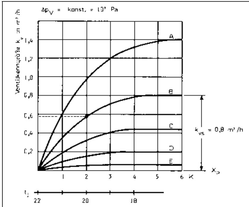
Bild 4: Beispiele für Ventilkennlinien
