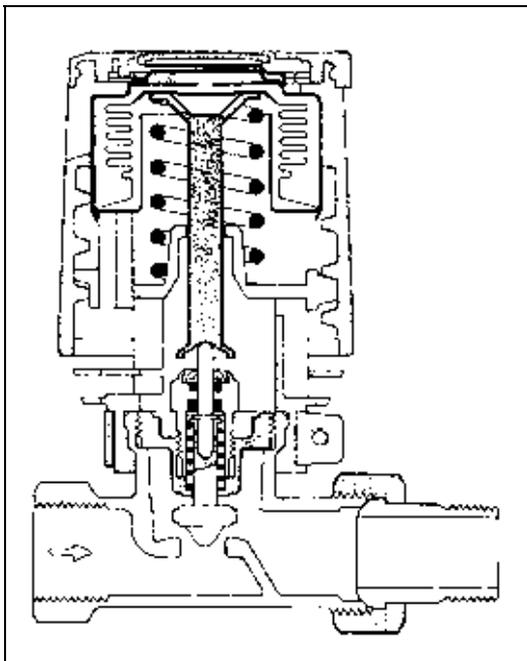
Bild 1: Schematische Darstellung eines Thermostatventils
