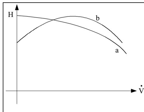
Bild 5 a. Pumpen mit stabiler Kennlinie
