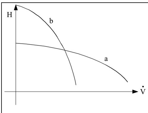
Bild 4 a. Pumpen mit flacher Kennlinie
