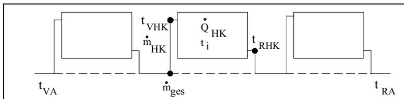
Bild 7: Einrohrheizung mit Nebenschluss
