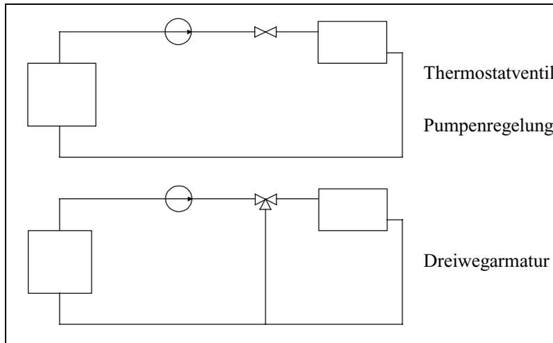
Bild 2: Schaltungen zur Massenstromregelung
