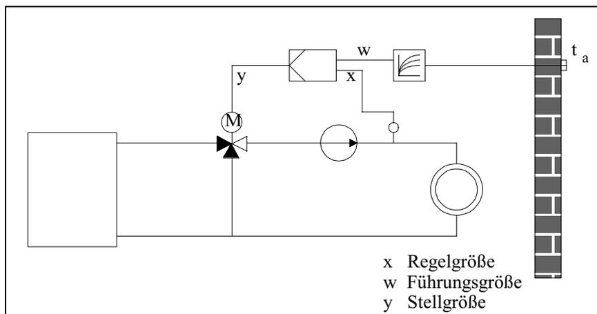
Bild 4: Vorlauftemperaturregelung mit 3-Weg-Ventil
